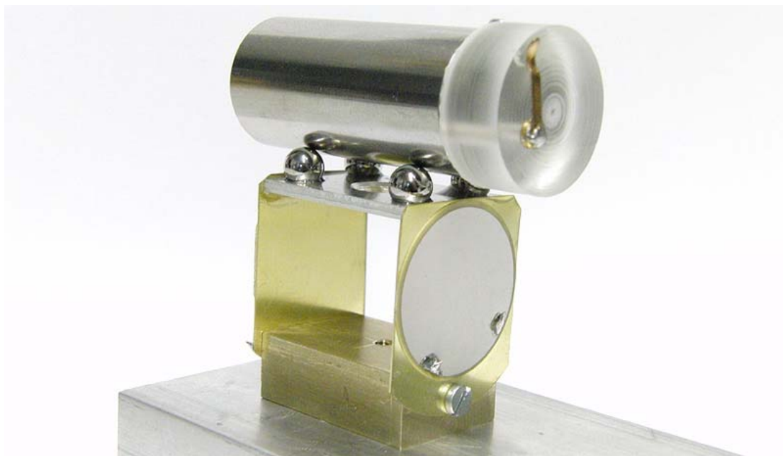
Abb. 40: Trägheitsmotor mit Piezo-Beepern
