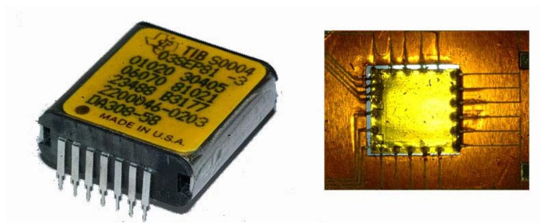
**Abb. 51: Magnetblasen-Speicher und der im Inneren befindliche YIG-Chip**
