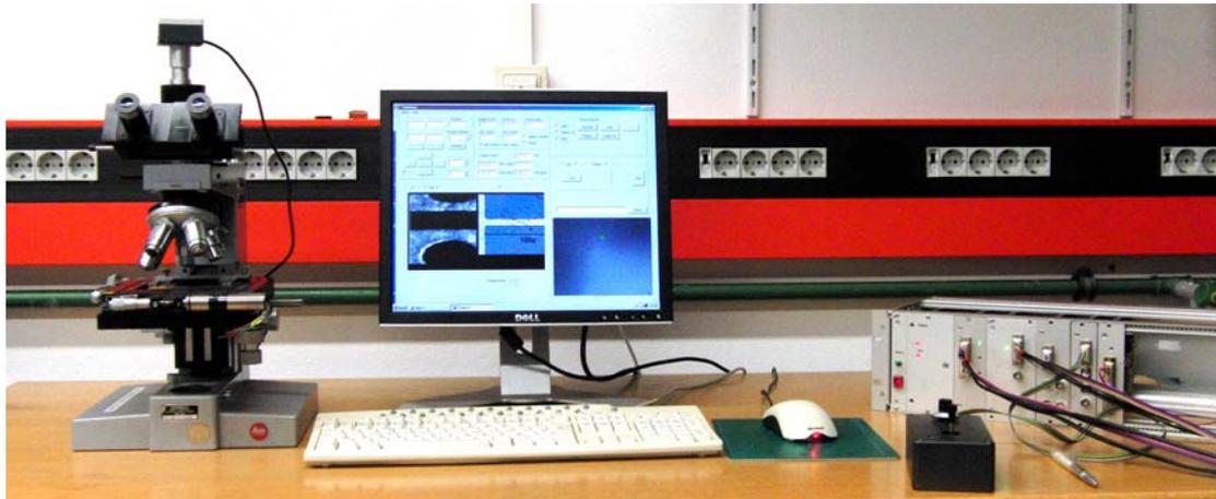
**Abb. 1: Zum Lasermikroskop umgebautes Forschungsmikroskop**
