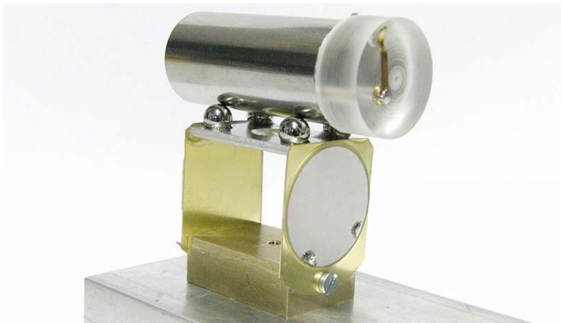
**Abb. 40: Trägheitsmotor mit Piezo-Beepern**
