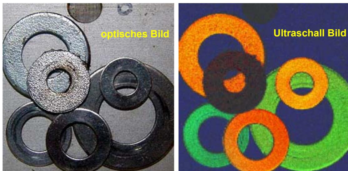
**Abb. 61: Ultraschallabbildung durch unterschiedliche Laufzeiten**
