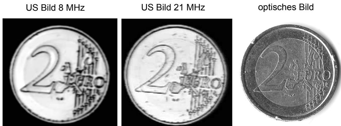
Abb. 49: Abbildung eines 2 Euro Stücks mit verschiedenen Frequenzen
