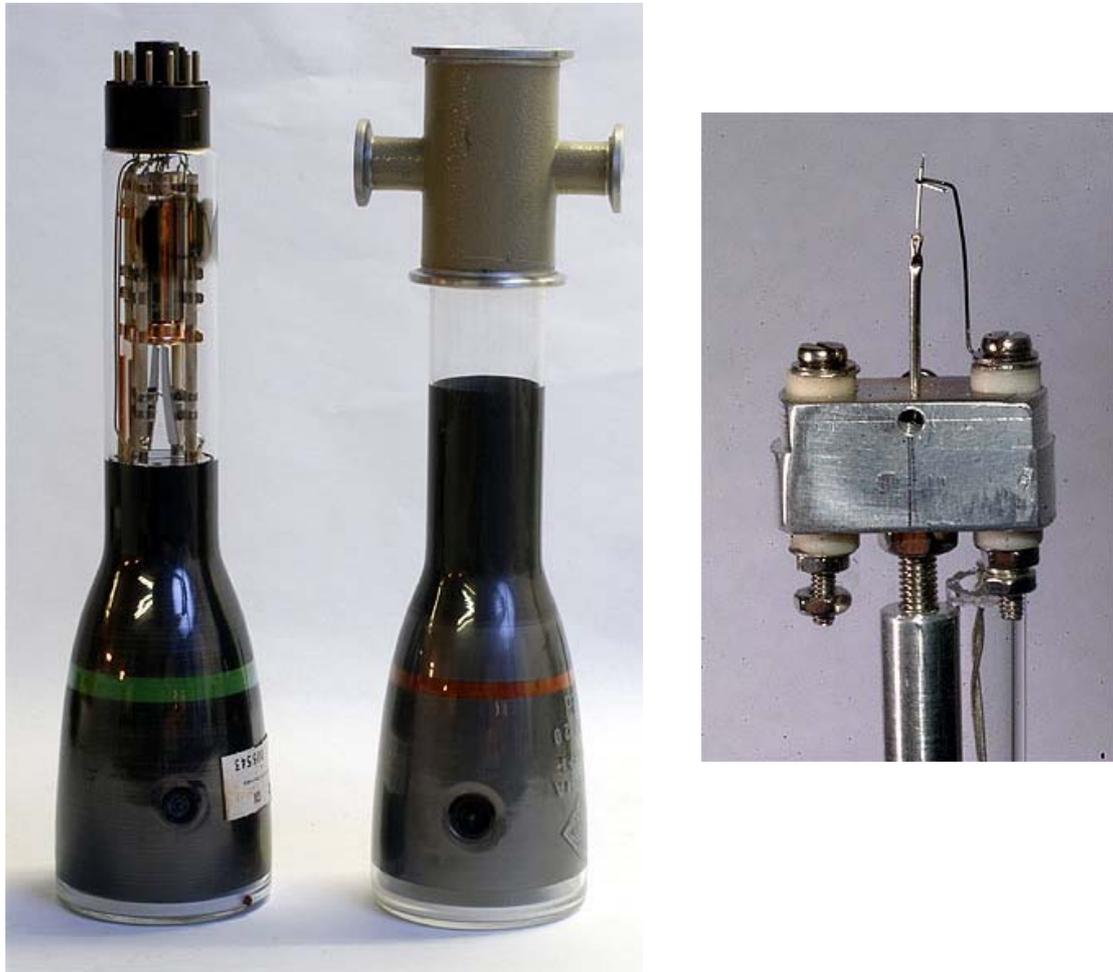
**Abb. 75: Zwei Oszirrohren DG 7-74A, und der Spitzenthalter**
