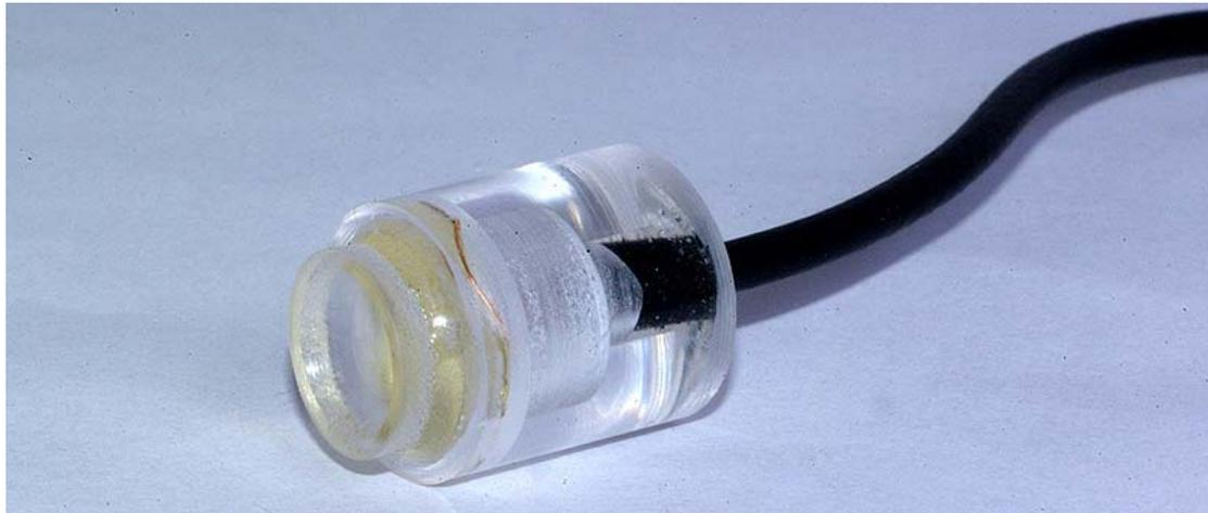
**Abb. 10: Einfacher Transducer mit Plexiglaslinse**
