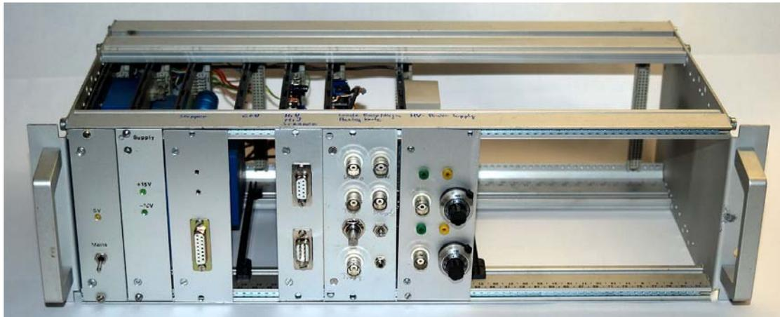
**Abb. 44: Elektronik des Ultraschallmikroskops**
